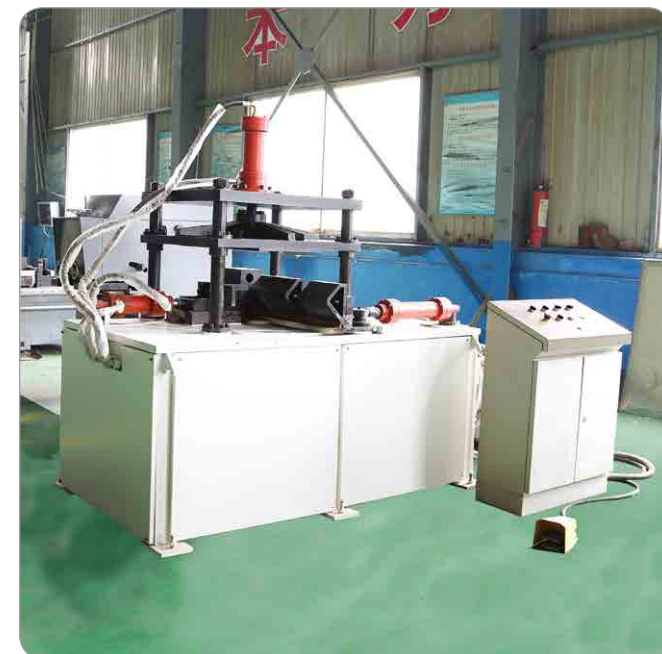
YQW-200 型 加工角钢范围 Angle steel size(mm): L40×40×3—L200×200×20 YQW-160 型 加工角钢范围 Angle steel size(mm): L40×40×3—L160×160×12
