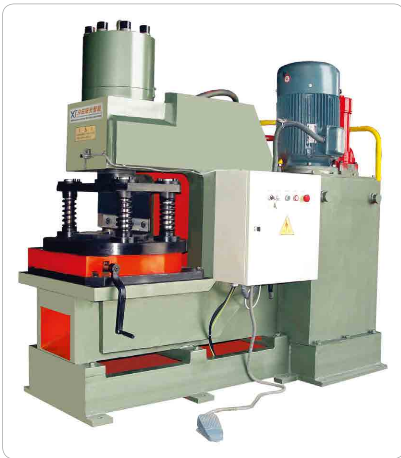
YQJ-160 型加工角钢范围 Angle steel size(mm): L40×40×3—L160×160×12
