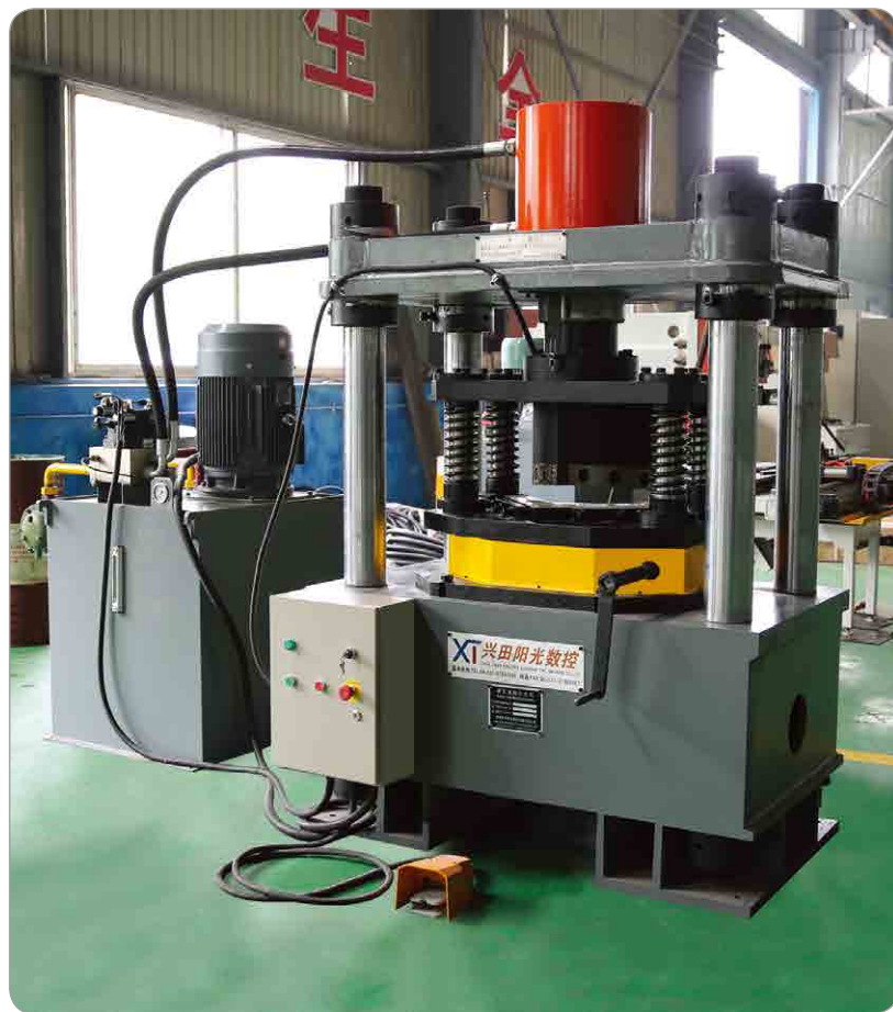
YQJ-200 型 加工角钢范围 Angle steel size(mm): L40×40×3—L200×200×20
